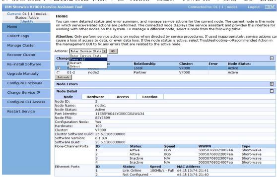
4) 等待 Node 1 Power off 任务执行完毕。控制器的电源和风扇会随即关闭。等待风扇关闭之后,手动关闭机头的两个电源模块的开关就行了。
