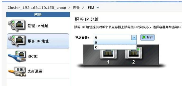
3. 设置 iSCSI 网络地址，可以为每个控制器上的两个以太网口设置独立的用于 iSCSI 访问的 IP 地址。服务器上的 iSCSI Initiator 软件通过此地址访问存储。
