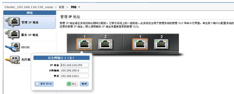
2. 设置服务 IP 地址，可以为每个控制器的网口 1 指定服务 IP 地址，此地址是用来访问服务助手工具的，可以通过此工具查看控制器连接状态，错误日志等。
