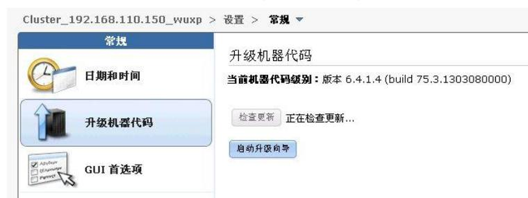
2. 如果有更新的代码级别需要刷新，选择启动升级向导，V3500/3700 更新代码除了要下载新版本代码，例如 StorageDisk-2071-6.4.1.4，还需要下载一个升级测试实用程序，例如 StorageDisk-2071-SwUpgradeTestUtility V3500 下载
