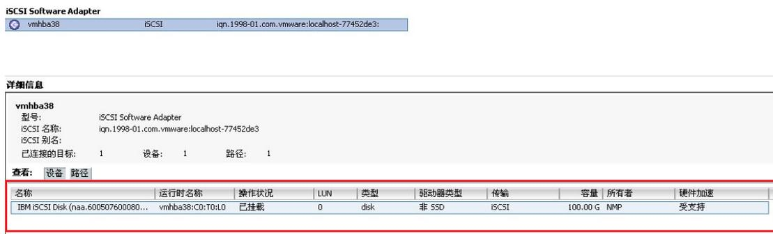
9. 点击路径按键，可以看到此设备包含有两条路径，说明与 V3500/3700 两个控制器的 iSCSI 连接都是正常的，VMware 系统本身包含有多路径软件，无需额外安装。
