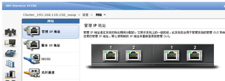
1. 设置管理 IP 地址，此地址是用来访问 V3500/3700 管理页面(GUI)的，注意设置网口 1 的 IP 地址将同时的应用到两个控制器上，如果需要冗余的管理地址，可以为网口 2 设置 IP 地址，同样也是应用到两个控制器上的。
