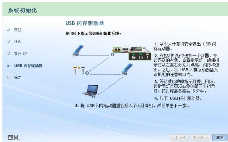
5. 初始化操作完成后, 将 USB Key 从控制器取下, 重新插入刚刚的 PC 或者笔记本中, 正确识别 USB Key 后点击下一步, 如果操作完成工具中会显示成功的提示, 如果操作失败也会显示在此界面中。
