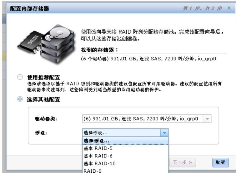
3. 选中优化容量，输入要配置在 RAID 中的硬盘数量，默认勾选了自动配置备件选项，会自动创建一个热备份盘，如果不需要热备份盘可以去掉这个选项，在配置摘要中描述了当前的 RAID 配置方式，检查无误后点击下一步。
